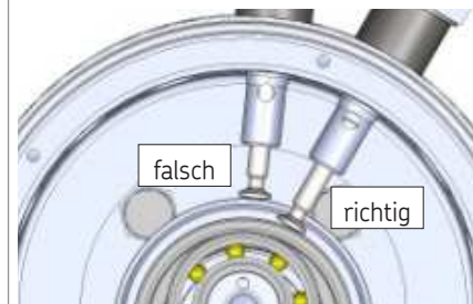
Pumpenelement Montage Abb. 9
